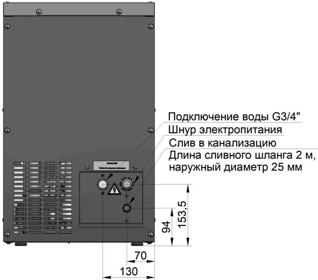
Рис. 5 Схема подключения льдогенератора
